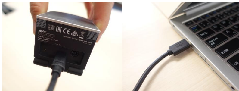
カメラユニット背面端子には Type-C で接続し、PC の USB ポートへは USB(3.0)接続する。
