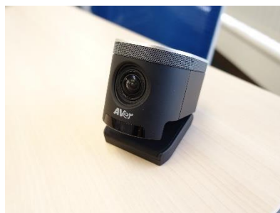
CAM340+ (折りたたみ式取付マウントをスタンドにしたところ)
