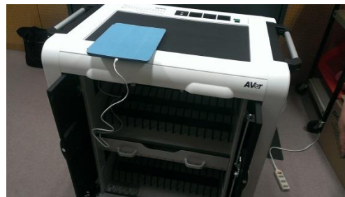
*今回ご寄贈の「Tabsync」と既に学校使用中のiPad。 ライトニングケーブルを繋げるだけで、かんたんに充電・同期・保管が出来ます。
